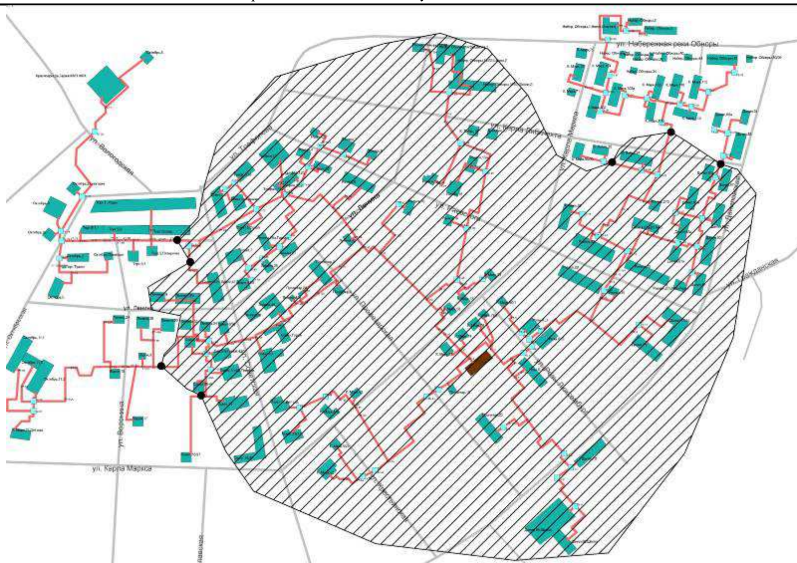
Рис. 4. Зона эффективного теплоснабжения для центральной котельной
