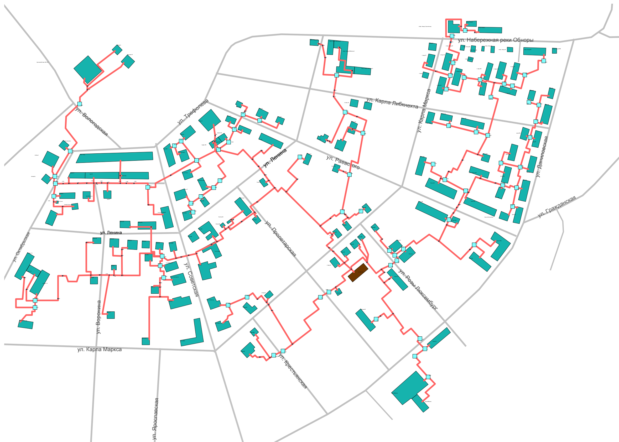
Схема тепловых сетей (отопление) центральной котельной
